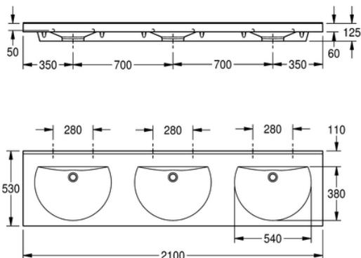
Reihenwaschtisch RONDA aus kunstharzgebundenem Mineralwerkstoff MIRANIT mit porenfreier, glatter Oberfläche (temperaturbeständig bis 80°C). Mit drei nahtlos eingeformten, runden Mulden, ohne Überlauf. Angeformte Rückwand mit integrierten Konsolen und Befestigungsbohrungen. Hintere Schwallkante. Schürze. Ohne Armaturenbohrungen, inklusive Befestigungsmaterial (Stockschrauben und Dübel).
